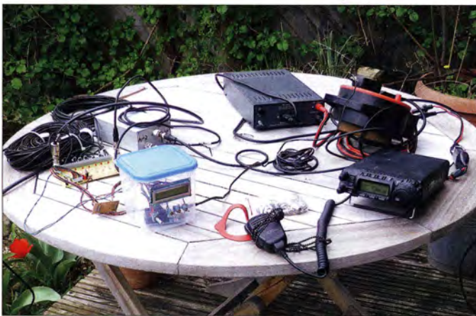
Bild 11: Gartentisch mit FT-857 und Schaltnetzteil Emtron EPS-20s rechts sowie der Steuerbox samt Display in der Kunststoffdose mit blauem Deckel links; schräg dahinter liegen die Relaisplatine mit den Kabelrollen der Umwegleitungen und der Transformator im Aluminiumgehäuse.
