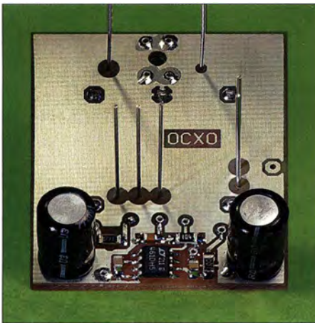
Bild 7: Zur Montage vorbereitete Grundleiterplatte des OCXO Fotos: DM2DSN
