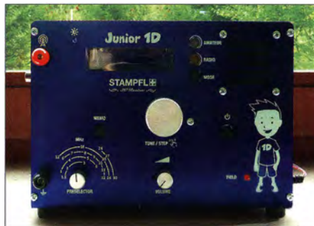
Heinz Stampfl, HB9KOC, stellte seinen neuen, jetzt von 1,5 MHz bis 30 MHz durchstimmbaren sowie mit Preselektor und Frequenzanzeige ausgestatteten Radiobausatz Junior 1D vor, der wieder beim FA-Leserservice erhältlich sein soll.
