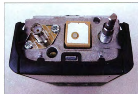
Bild 10: Die GPS-Antenne empfängt selbst noch in Innenräumen.
