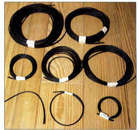
Bild 10: Ansicht der acht zugeschnittenen Umwegleitungen aus Koaxialkabel RG174
