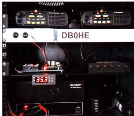
Zwei Betriebsfunkgeräte Motorola GM340 bilden die Basis von DB0HE. Foto: DL5BQ
