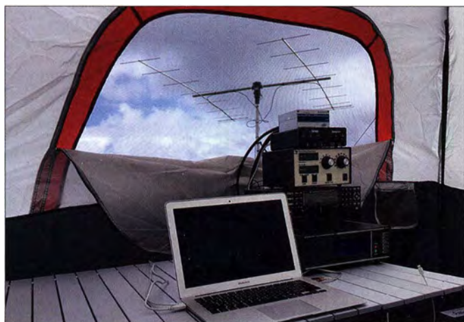
Da war noch alles in Ordnung: die zwei 9-Element-Yagis und das Shack-Zelt
